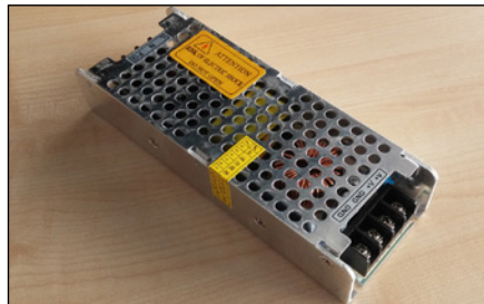
TTQR Transformador – 24V, 100W, silencioso.
