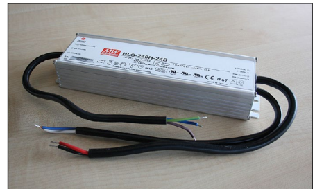
TTQR regulador de intensidad, 240W, 24V.
